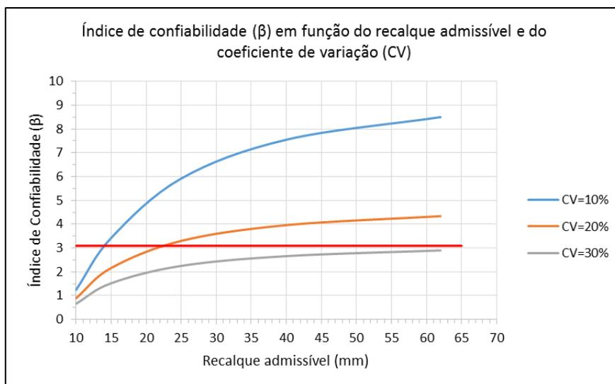
Figura 2. Distribuição de  $\beta$  em função do coeficiente de variação do recalque admissível.
