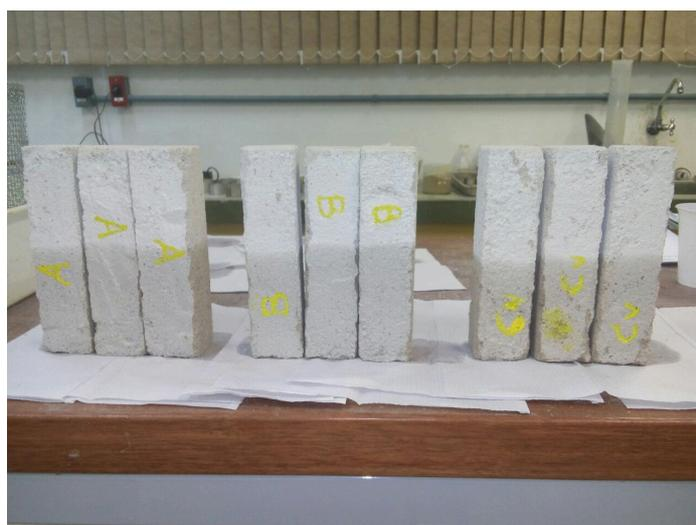
Figura 6- Corpos de prova após o ensaio de absorção capilar.
