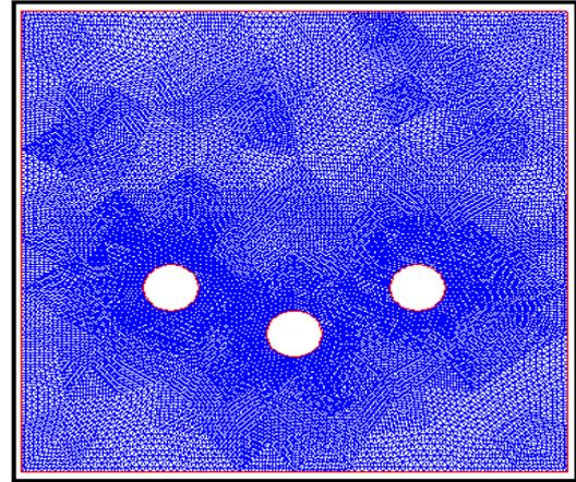
Figura 5: Malha após o terceiro refino.
