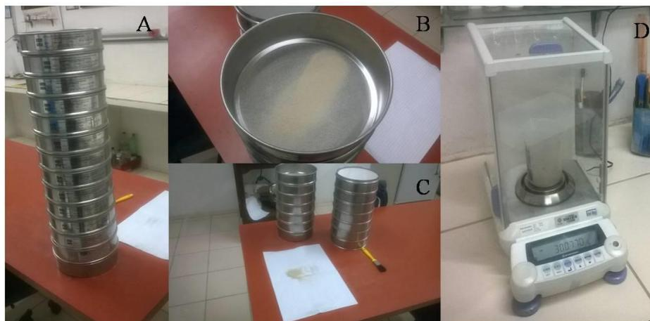
Figura 3. Conjunto de peneiras (A), material retido na peneira 2,5  $\phi$  (B), removido da peneira (C) e pesado em balança analítica (D).
