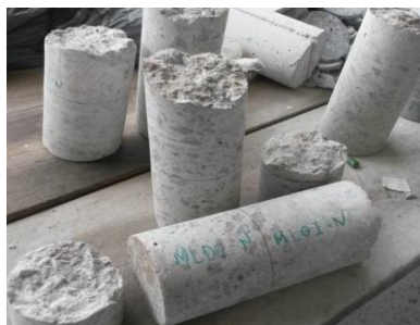
Figura 5. Testemunhos extraídos dos microambientes.
