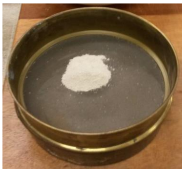
Figura 10. Peneiramento da amostra após processo manual e final de moagem.
