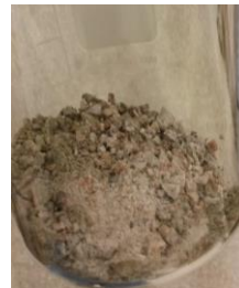
Figura 8. Resultado da moagem manual de uma camada.
