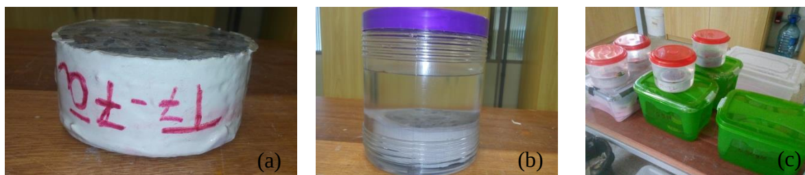
Figura 03 – Processo de contaminação das amostras. (a) Amostra identificada e revestida com resina epóxi. (b) Amostra imersa em solução de NaCl . (c) Armazenamento das amostras em laboratório com temperatura controlada.
