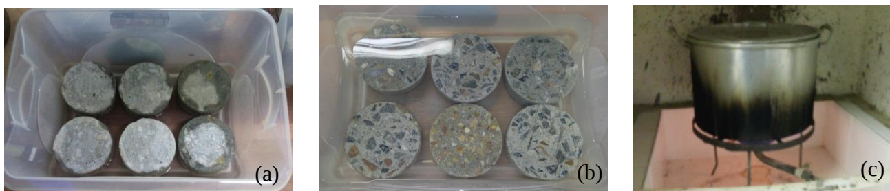
Figura 02 – Procedimento utilizado para estabelecer a saturação das amostras. (a) Amostras imersas em 1/3 do seu volume. (b) Amostras completamente imersas por um período de 64h. (c) Ebulição das amostras por 5h.
