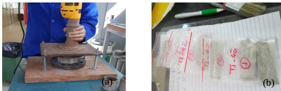
Figura 04 – Processo de extração das amostras. (a) Extração em equipamento projetado para obtenção das amostras de forma pulverizada. (b) Armazenamento da amostra pulverizada.
