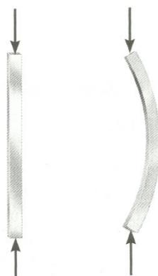
Figura 1. Flambagem Mecânica (Hibbeler, 2010).
